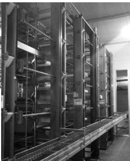
Sběr vajec v hale s šesti- patrovým lift systémem.
